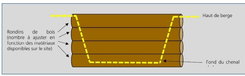
Schéma de principe des seuils à aménager
