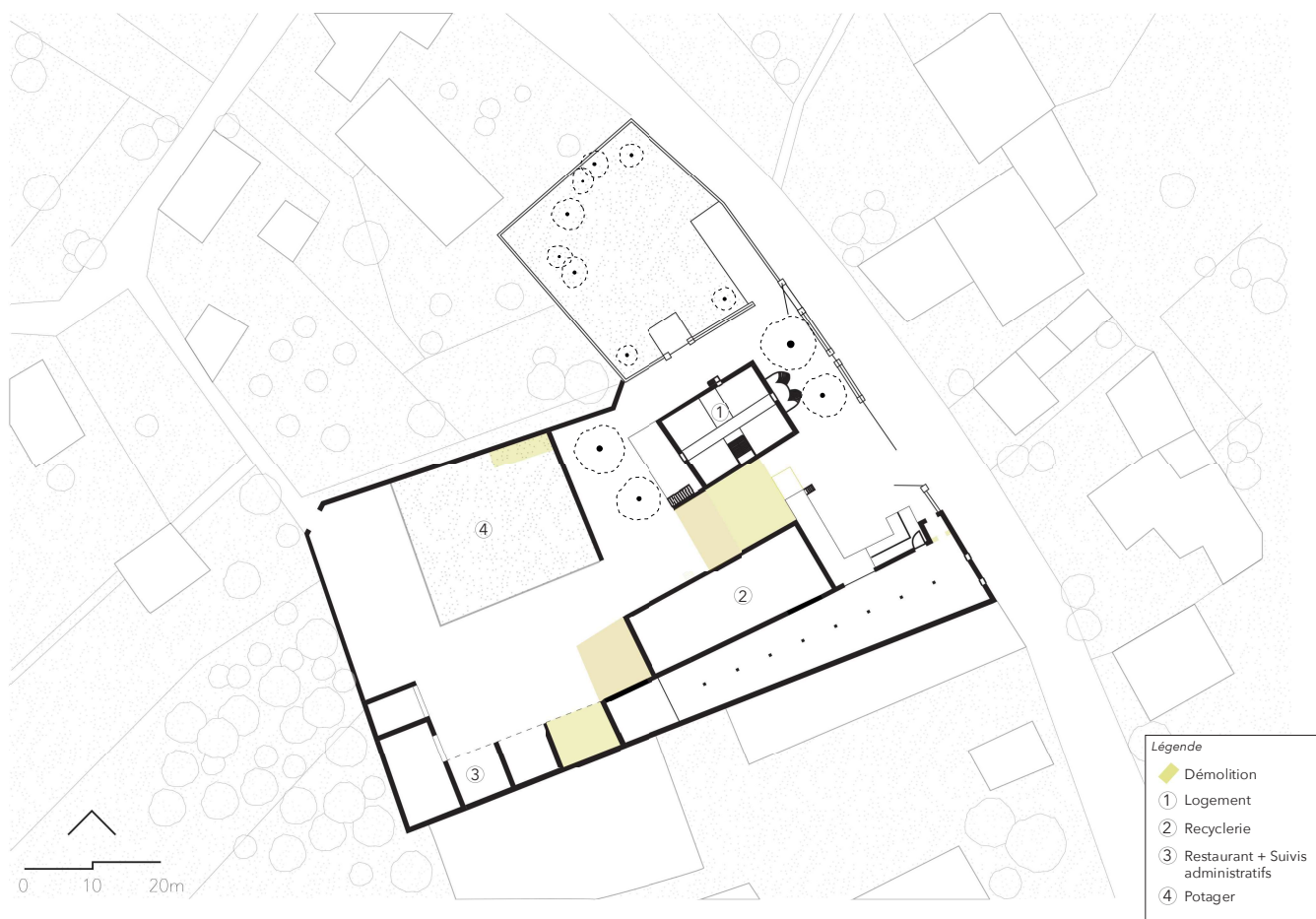
Démolitions mesurées pour révéler le bâtiment
