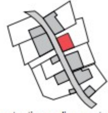
Construction en alignement : ok
