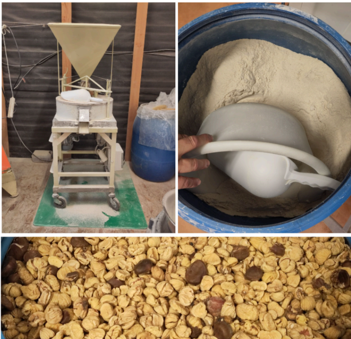
Figure 88 : Photos d'un petit moulin à blé employé pour moudre des châtaignes sèches (haut gauche), Farine de châtaigne (haut droit), Châtaignes entières après séchage et passage à la pise (bas); Source : autrice
