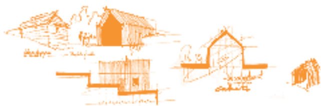
Intégration d'une maison dans la pente (schéma en coupe)
