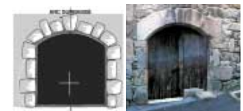
L'arc surbaissé est une portion d'arc de cercle posé sur les jambages.
