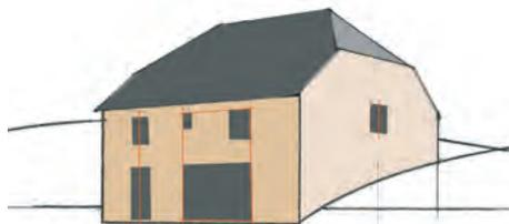
Il est possible de créer au rez-de-chaussée une large ouverture, dans l'axe des fenêtres, pour une porte de garage, une façade commerciale.
