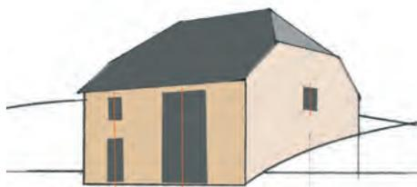
Un élément d'architecture plus contemporain peut être envisagé en élevant sur toute la hauteur l'ouverture. Cela nécessite cependant un soin très particulier dans sa mise en oeuvre.
