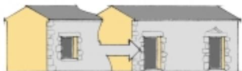
Une fenêtre peut être transformée en porte vitrée pour apporter juste un peu plus de lumière (le linteau qui est la pièce la plus difficile à transformer reste ainsi en place)
