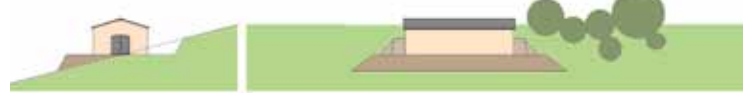
Hangar agricole de taille raisonnable dont l'implantation nécessite peu de travaux de terrassement et dont l'impact visuel paysager est faible.
