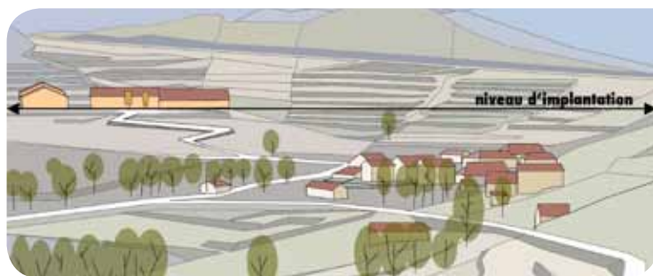
Bâtiment agricole implanté à proximité d'un village, trop visible sur la pente, avec un chemin d'accès complexe et trop large (effet cicatrice).
