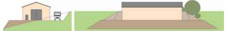
Bâtiment (plus grand et volumineux) avec un terrassement beaucoup plus visible, même en étant bien équilibré (le déblai est égal au remblai).
